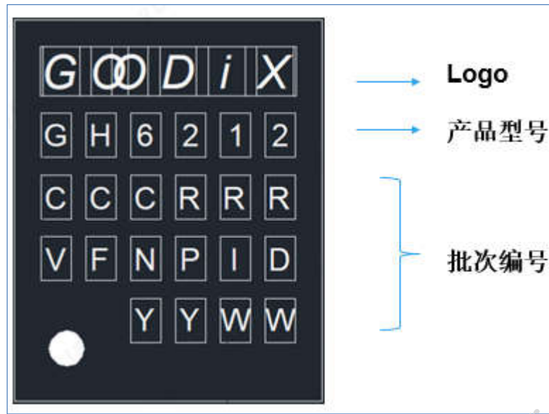
图 8-2 封装标识 (Top View)
