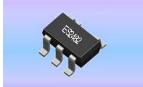
当南极磁场垂直于霍尔传感器的磁场强度超过工作点( $B_{OPs}$ )，ES2482 输出晶体管的 1 将会变低(打开)，输出电压为  $V_{DS}$ ，当南极磁场减少并且低于释放点的时候，输出晶体管 1 将会变高(关闭)。当北极磁场垂直于霍尔传感器的磁场强度超过工作点( $B_{OPN}$ )，ES2482 输出晶体管的 2 将会变低(打开)输出电压为  $V_{DS}$ ，当北极磁场减少并且低于释放点的时候，输出晶体管 2 将会变高(关闭)。元件的工作点和释放点的差值为元件的磁滞。
