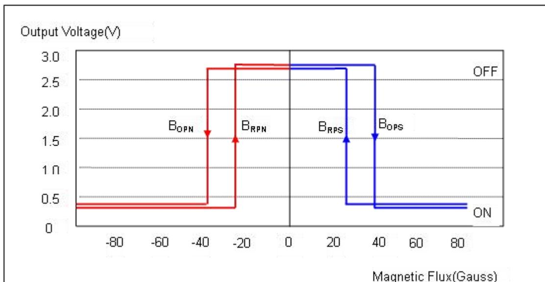
测试条件:  $T_A = 25^\circ\text{C}$ ,  $V_{DD} = 3\text{V}_{DC}$
