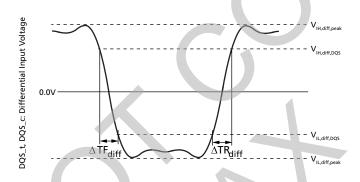
Table 101: DDR4-1600 through DDR4-2400 Differential Input Slew Rate and Input Levels for DQS\_t, DQS\_c
