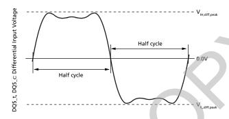
Table 97: DDR4-1600 through DDR4-2400 Differential Input Swing Requirements for DQS\_t, DQS\_c
