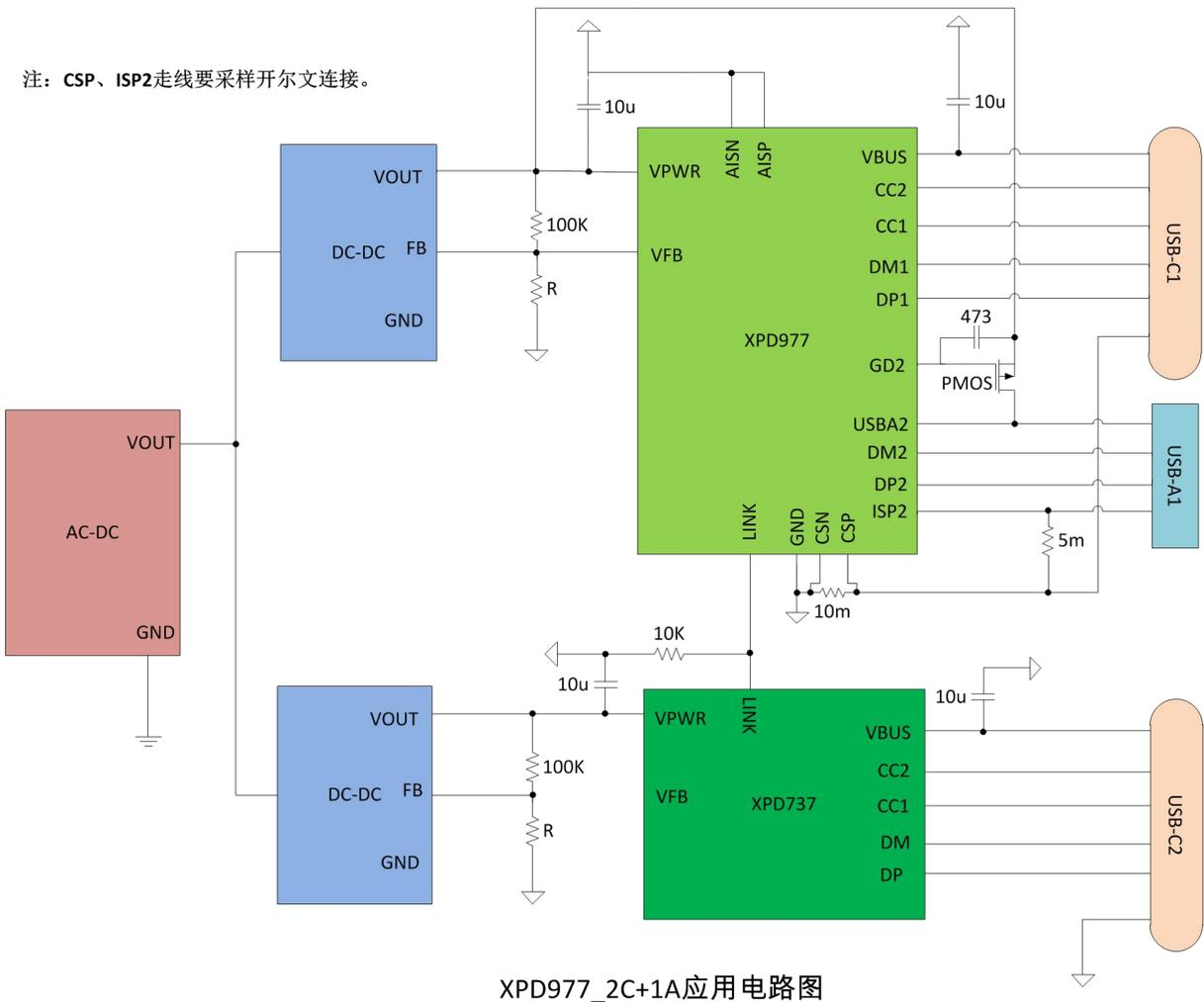
上面的应用电路图中, 使用一颗 XPD977 控制 USB-C1 端口和 USB-A1 端口, 一颗 XPD737 控制 USB-C2 端口。XPD977 和 XPD737 的 VFB 分别连接到两路 DCDC 电源的反馈网络。XPD977 和 XPD737 通过 LINK 引脚连接到总线上。
