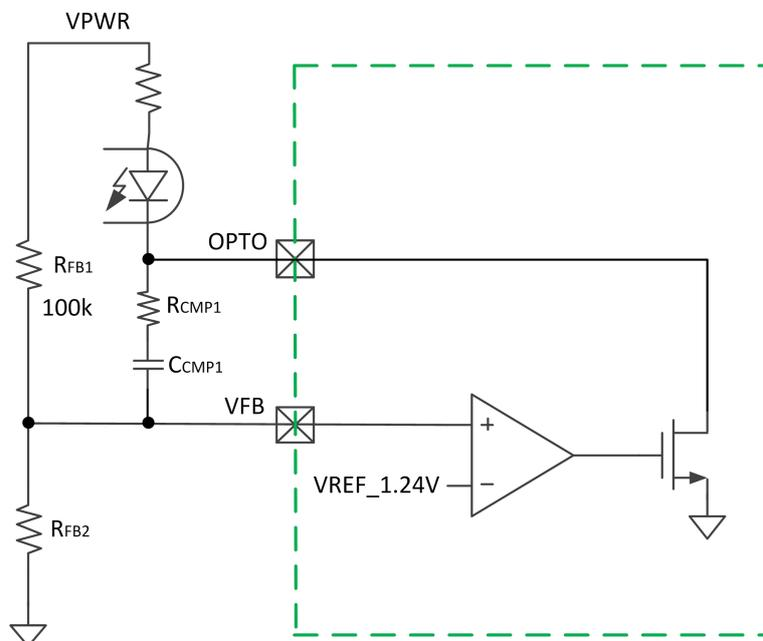
恒压环路（CV）需要在外部进行补偿，补偿电阻  $R_{CMP1}$  和补偿电容  $C_{CMP1}$  由具体应用决定。VFB 内部的基准电压为 1.24V。VPWR 上的反馈电阻网络的分压电阻  $R_{FB1}$  必须接 100 kΩ。
